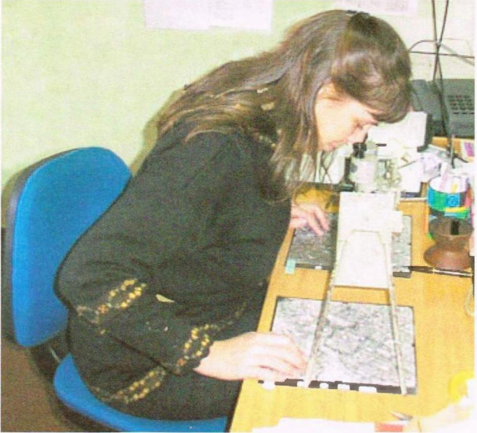
**Foto 1:** Este equipo llamado estereoscopio de espejos permite analizar las modificaciones en el terreno al dar al operador visión tridimensional a partir de dos fotos secuenciales.
